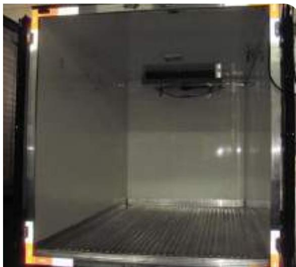
Veículos isotérmicos, com paredes lisas, impermeáveis, piso em aço inox ou alumínio e com climatizador são ideais para controlar a temperatura, conforme faixa escolhida
